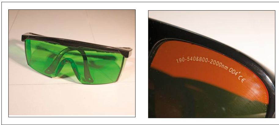
Figuur 3. De groene bril die bij beide modellen wordt geleverd biedt geen bescherming! Een goede bril moet OD4+ en CE-markeringen hebben.
